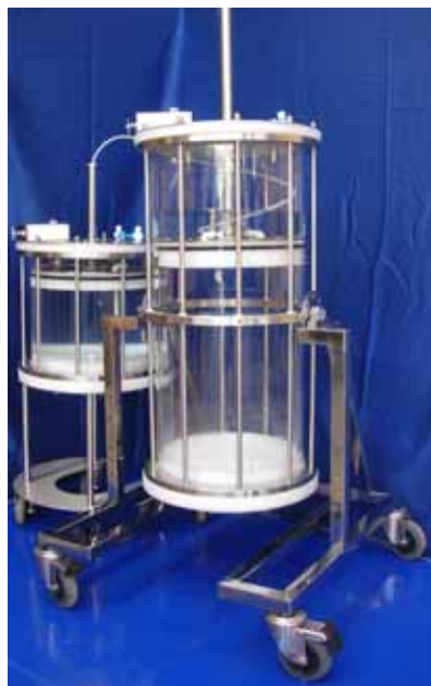
Колонна низкого давления для очистки белков
